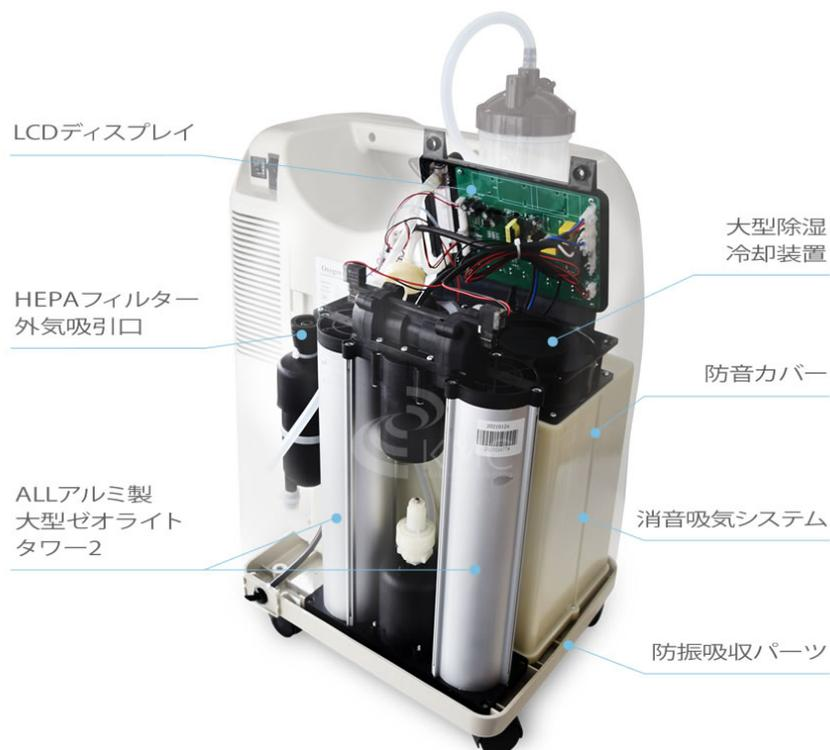
5Lまで93%以上の高濃度酸素を安定供給する為に最新の大型冷却装置やオイルレス圧縮ポンプを採用、高濃度酸素を生成するフランス製ALLアルミ製の大型ゼオライトタワーを2機配置し高濃度酸素を安定供給します。
